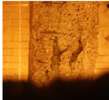
Bild 3 Abfall der Druckfestigkeit von Normalbeton und ultrahochfestem Beton (UHPC) bei hohen Temperaturbeanspruchungen (links) und Stütze aus UHPC mit Abplatzungen (rechts)
